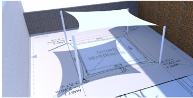
Ermittlung der Einstrahlungsrichtung in der Einbausituation
